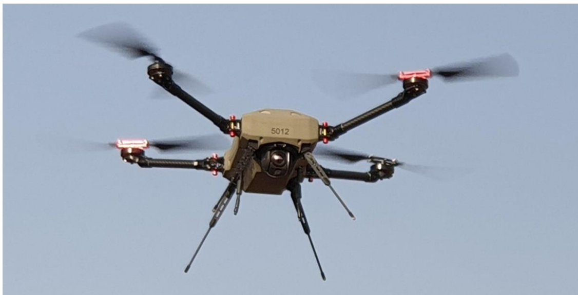
FIGURA 17- ARP MAGNI da Elbit Systems com uma câmera de alta resolução e EVN (payload) Fonte: https://elbitsystems.com/product/magni/
