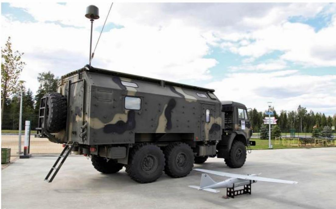
Figura 4 – Estação Leer-3, plataforma que possivelmente tem vários equipamentos que permitem a disseminação de informações por estação rádio, obtenção de dados de mídias sociais da Área de Operações e disseminação de mensagens para telefones celulares.
