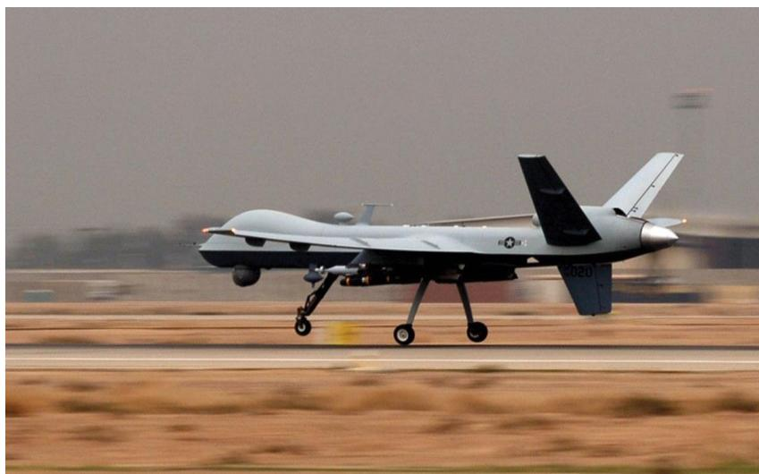
Imagem 05 - General Atomics MQ-9 Reaper, um veículo aéreo não tripulado de reconhecimento da Força Aérea dos EUA.
