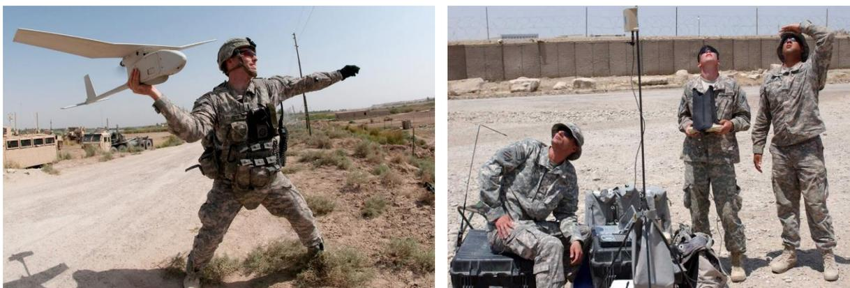
Imagem 07 – Lançamento e operação do RQ-11B UAV
