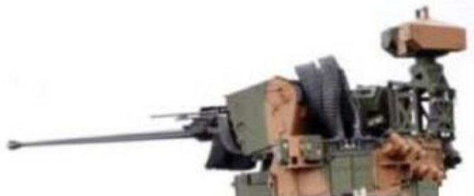
FIGURA 12: Canhão Automático 30x173 mm (UT30BR-Elbit). FONTE: http://www.epex.eb.mil.br/index.php/ultimas-noticias/625-torre-ut-30-novo-visual-e-totalmente-remodelada-pela-elbit-systems
