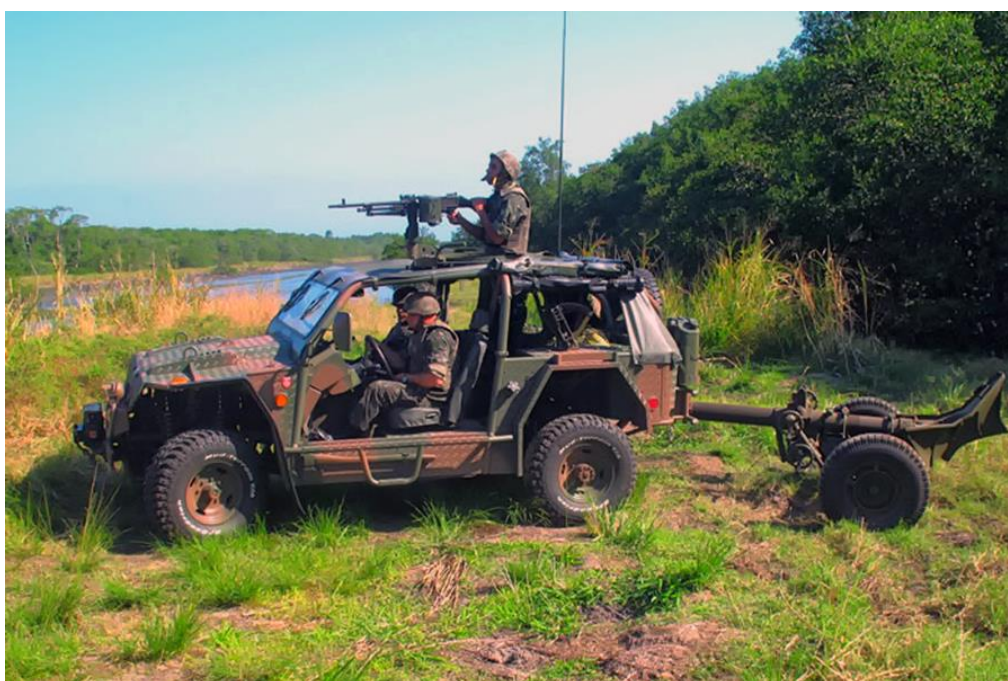
FIGURA 5- Mtr 120 mm sendo transportado por Vtr não especializada Fonte: Autor desconhecido
