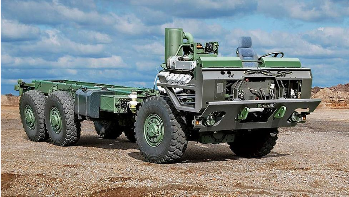
FIGURA 30- Chassi TATRA T 815-7T3B31 6x6.1R Fonte: Sítio eletrônico da empresa TATRA Motors
