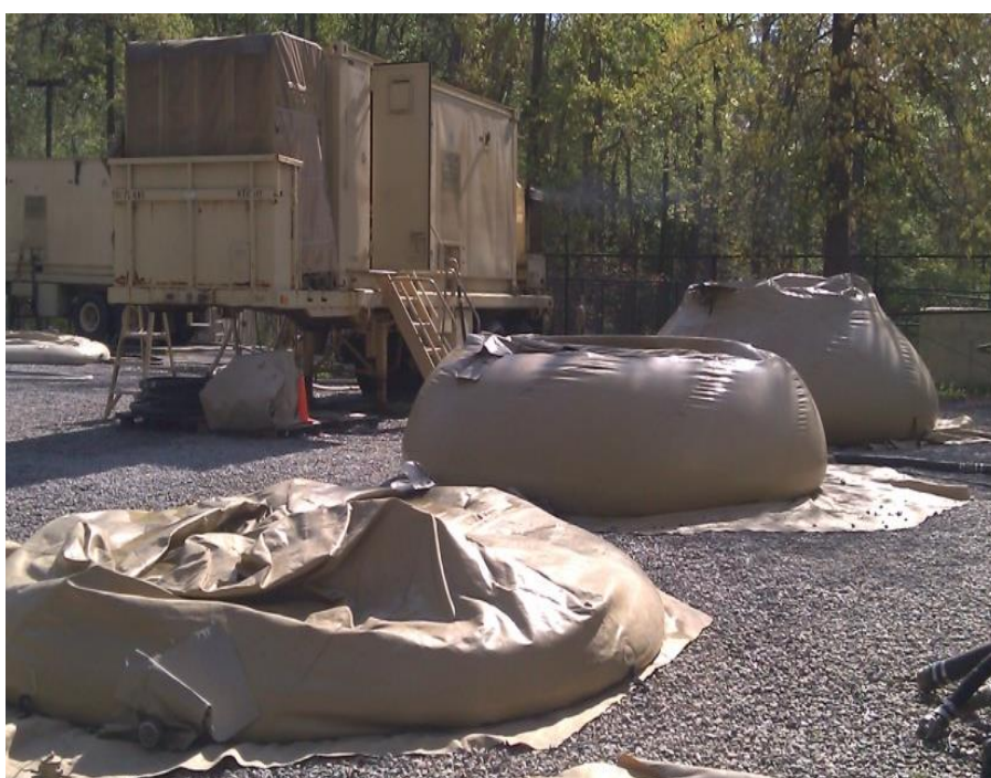
FIGURA 24- Reservatório tipo Plotter.
