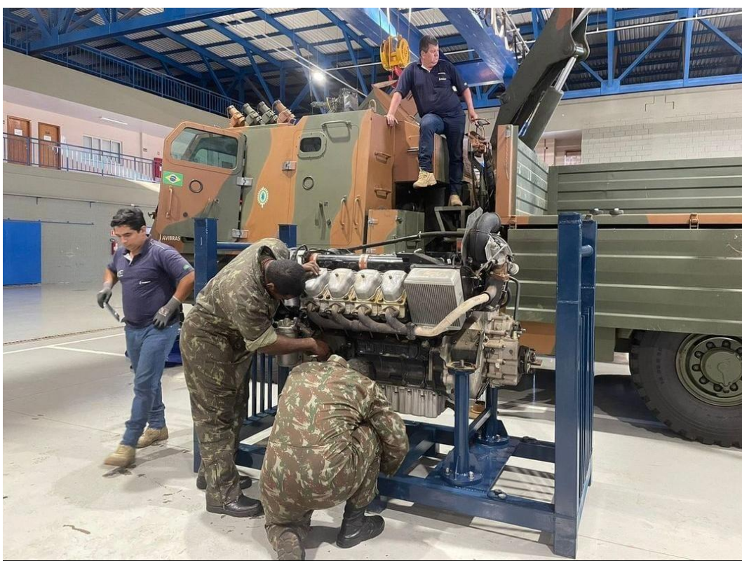
Figura 1 – Funcionários da AVIBRAS e militares do EB realizando manutenção em motor de uma viatura ASTROS no C Log Msl Fgt Fonte: O autor
