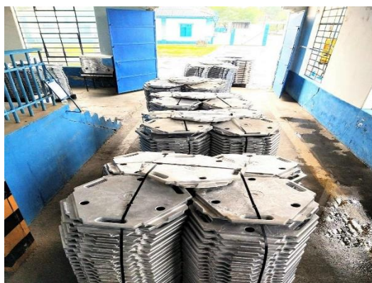
Figura 2: reforçadores de solo
