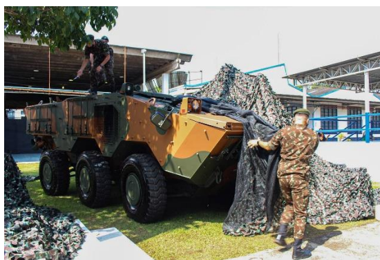
Figura 1: rede multiespectral sendo empregada em viatura
