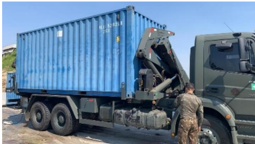
Figura 5- Caminhão içador “sidelift” da EB Operando no Porto de Porto Velho – RO
