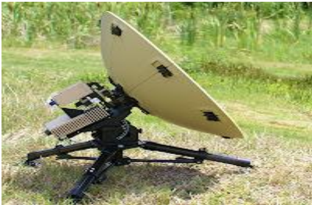
Figura 13: Um terminal VSAT transportável, significativamente maior em tamanho e peso do que BGAN.
