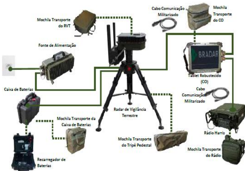
FIGURA 15 – Componentes do SVMR-T Fonte: (BRADAR EMBRAER DEFESA E SEGURANÇA, 2014, p. 10)
