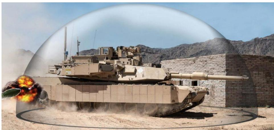
FIGURA 6- Ilustração do campo de força virtual que o APS Trophy cria em torno do tanque
