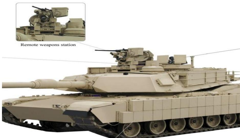
FIGURA 3- Abrams com Armas remotamente controladas
