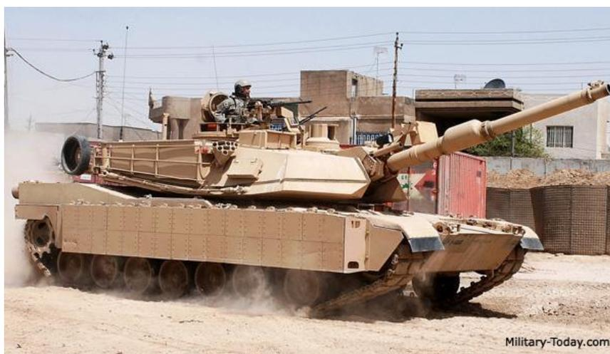
FIGURA 1- M1 Abrams dotado de Kit sobrevivência
