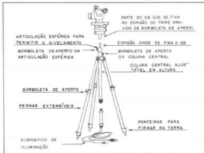
Figura 6 - Goniômetro-bússola e acessórios
