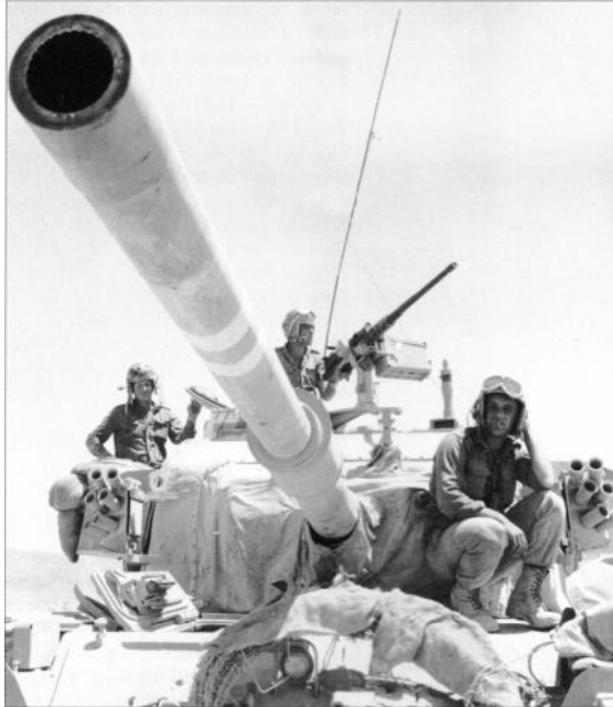
Figura 10 – Canhão L7 de 105 mm e metralhadora antiaérea 12,7 mm
