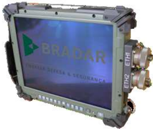
Figura 6: Console de operação do RVT transportável. Fonte: BRADAR, 2014, p. 23.
