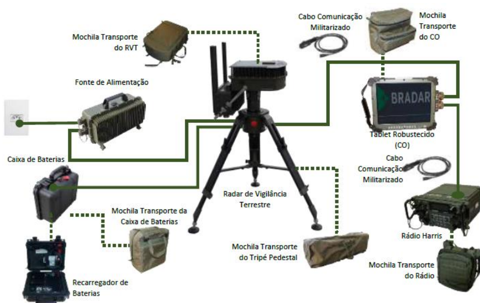
Figura 5: Componentes do RVT transportável. Fonte: BRADAR, 2014, p. 10.
