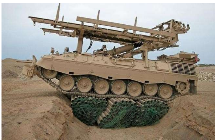
Figura 13: feixe de tubos sendo usado em transposição de vala Fonte: https://www.ffg-flensburg.de/en/heavy-tracks/leopard-support/ , acesso em 08/03/22.
