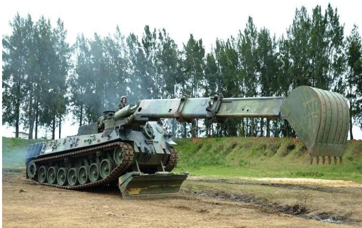
Figura 7 – Viatura Blindada de Combate de Engenharia
