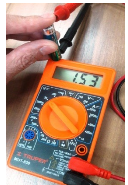
Fig 6. Multímetro digital sendo utilizado para a medição de tensão de uma pilha comum.
