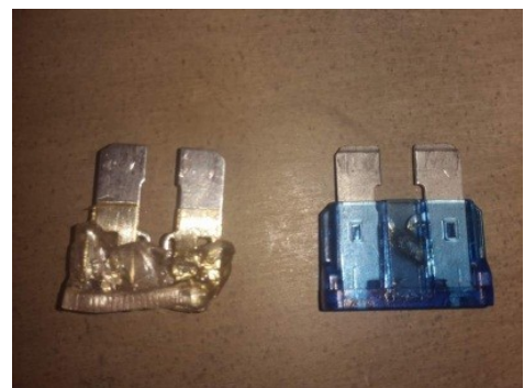
Fig 9. Fusíveis danificados por excesso de corrente. Observa-se visivelmente que os fusíveis estão “queimados”.
