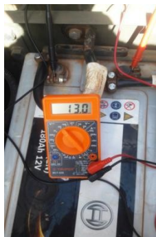
Fig 2. Multímetro digital sendo utilizado para a medição de tensão de uma bateria da viatura.
