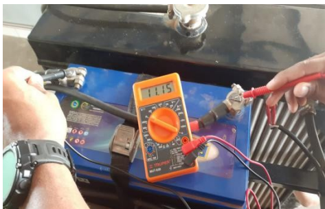
Fig 4. Multímetro digital sendo utilizado para a medição de tensão da bateria do gerador da Viatura Blindada Oficina (VBOfn-MSR).
