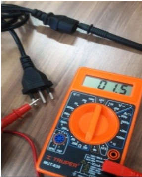
Fig 7. Multímetro digital sendo utilizado para fazer o teste de continuidade de um cabo elétrico.
