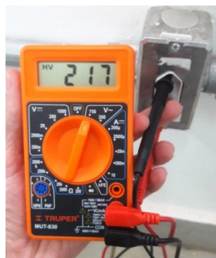
Fig 5. Multímetro digital sendo utilizado para a medição de tensão de uma tomada típica.
