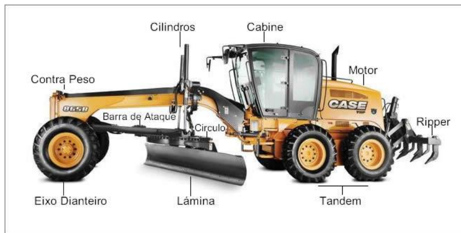
FIGURA 1 - PRINCIPAIS COMPONENTES DA MOTONIVELADORA 865B
