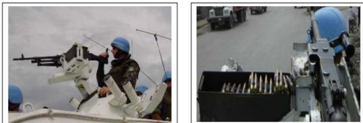
Figura 1: Adaptação da metralhadora MAG no reparo da Mtr.50 da VBTP URUTU
