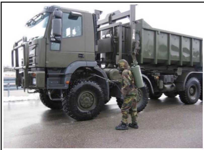
Fig 6-3 – Descon operacional física de viatura
