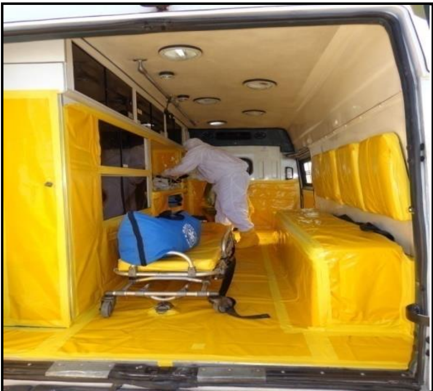
Fig 8-7 – Preparação de ambulância para transporte de contaminado
