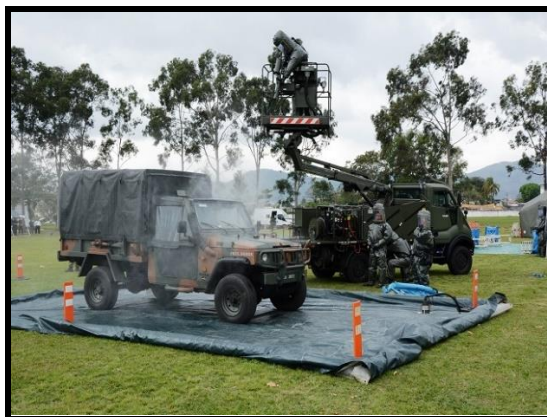
Fig 8-6 – Descontaminação de viatura com descontaminante à base de cloro
