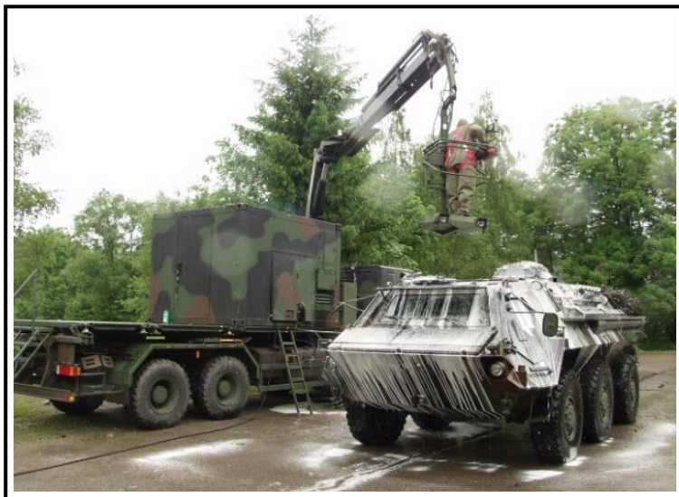
Fig 6-4 – Descon completa física de viatura
