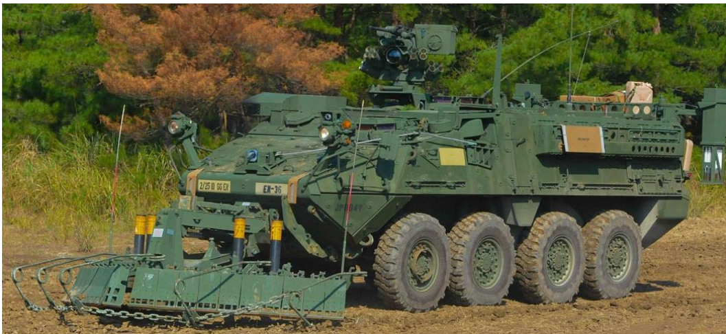
Fig 7 – VBE M 1132 com implemento para limpeza de via e balizamento Fonte: Sítio eletrônico “AFV DATABASESE”. Acesso em 09 Abr 2022
