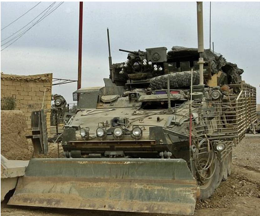
Fig 9 – VBE M 1132 com implemento lâmina dozer Fonte: Sítio eletrônico “AFV DATABESE”. Acesso em 09 Abr 2022
