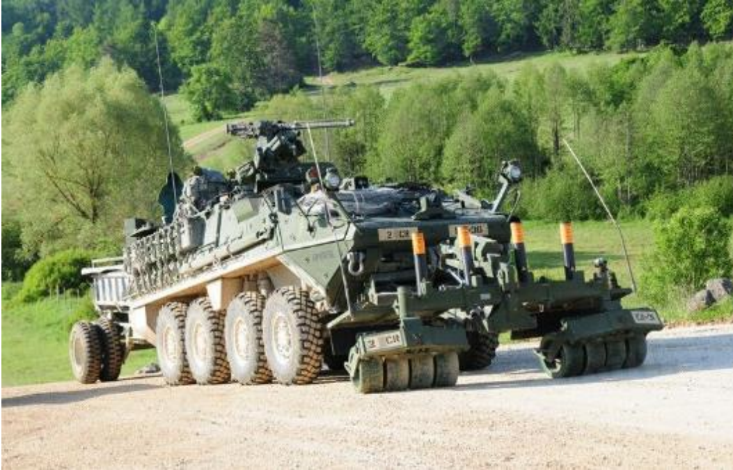
Fig 8 – VBE M 1132 com implemento rolo e MICLIC em semi-reboque Fonte: Sítio eletrônico “AFV DATABESE”. Acesso em 09 Abr 2022
