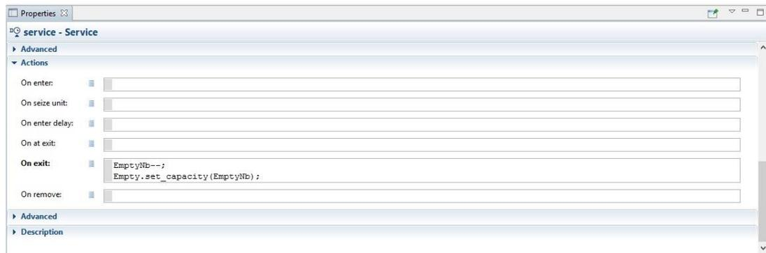
Figura 3.3: Ação à ser executada ao final do “service”
