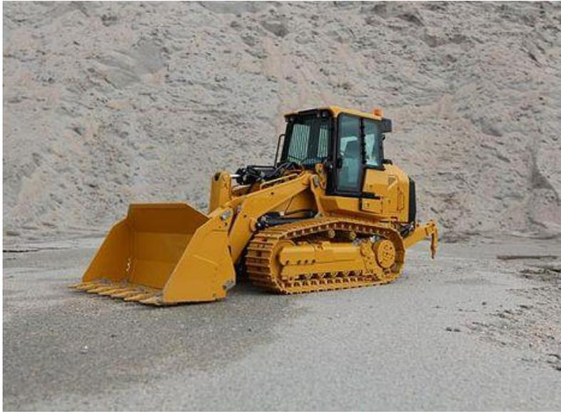
Figura 2.8: Pá-Carregadeira de Esteira 963D. Fonte: truckstrailers.com.br.
