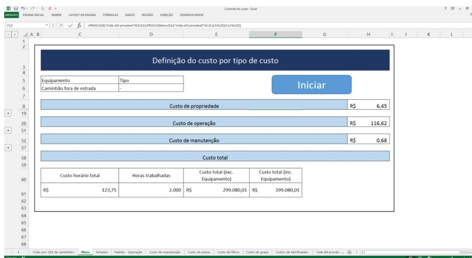
Figura 3.8: Ferramenta de cálculo de custo para equipamentos de terraplanagem.
