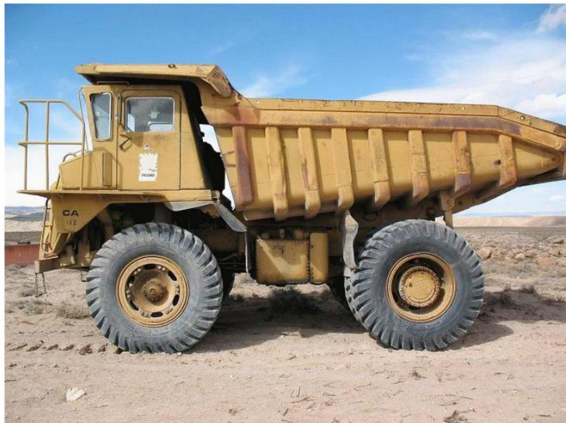
Figura 2.9: Caminhão Fora-de-Estrada CAT 769B. Fonte: br.minutemachine.com.
