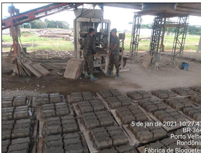
FIGURA 5 – Produção de bloquetes de concreto para pavimentação de arruamentos na nova sede da 17ª Bda Inf SI
