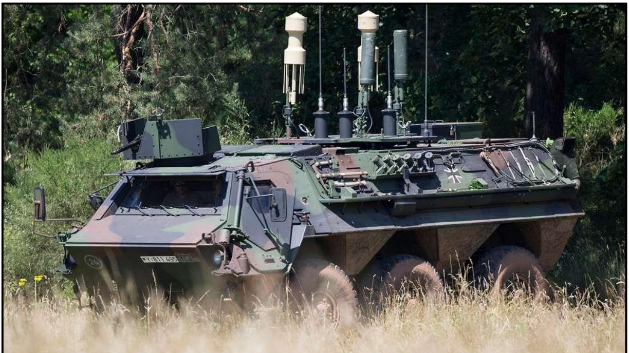
FIGURA 13 – Sistema de bloqueio protegido construído em um veículo de transporte blindado Fuchs. Fonte: ALEMANHA (2022).
