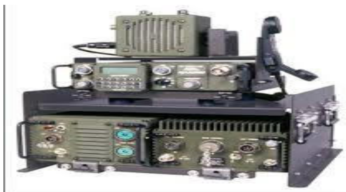
Figura 6 – Rádio Falcon MPR-9600 com amplificador
