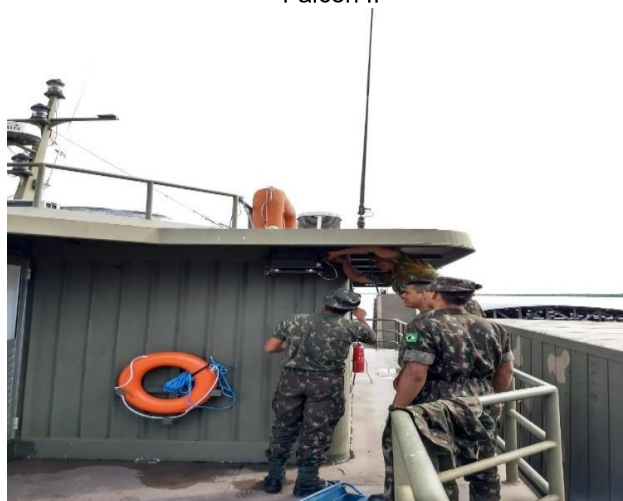
Figura 12 – Antena Vertical omnidirecional adaptada a embarcação utilizada nos rádios MPR-9600 Falcon II
