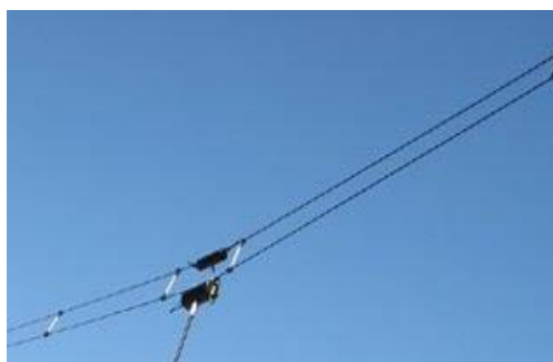
Figura 11 – Antena Dipolo Multibanda YA-30 unidirecional utilizada nas embarcações nos rádios YAESU SYSTEM 600
