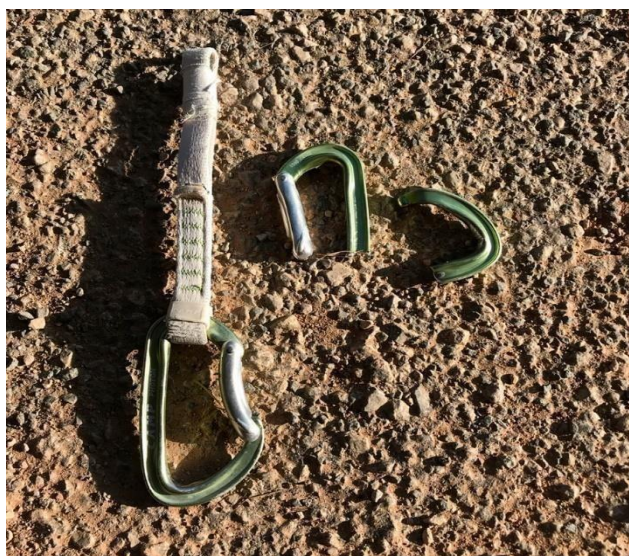
Figura 1 – Mosquetão simples quebrado Fonte: Fernandes (2018)
