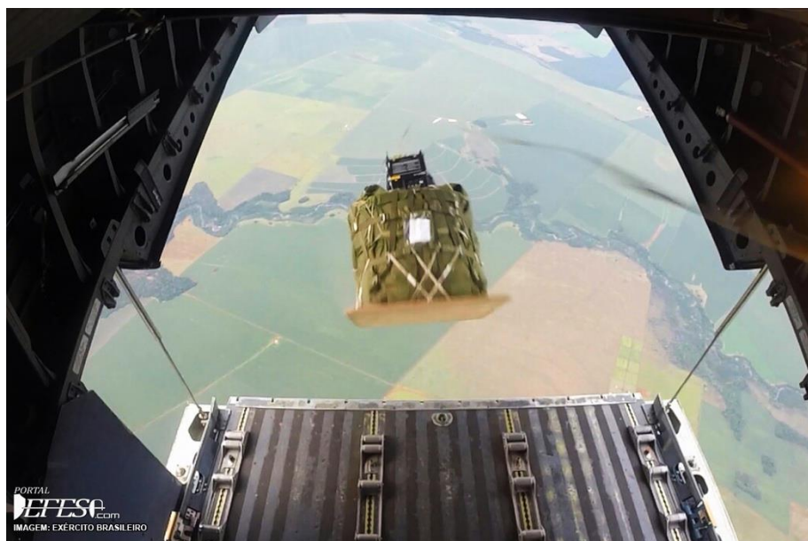
Figura 6 - Sherpa lançado como CDS, por gravidade.
