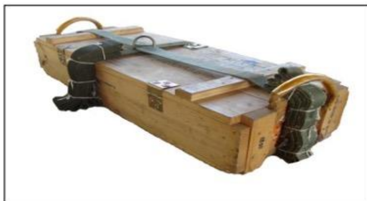
Figura 8 - Suprimento montado com cadarços de A-7A.
