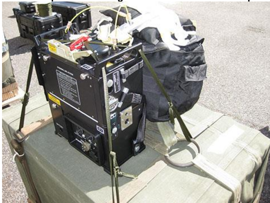
Figura 2 - Sherpa PADS - Ranger 700 - instalado em um suprimento.
