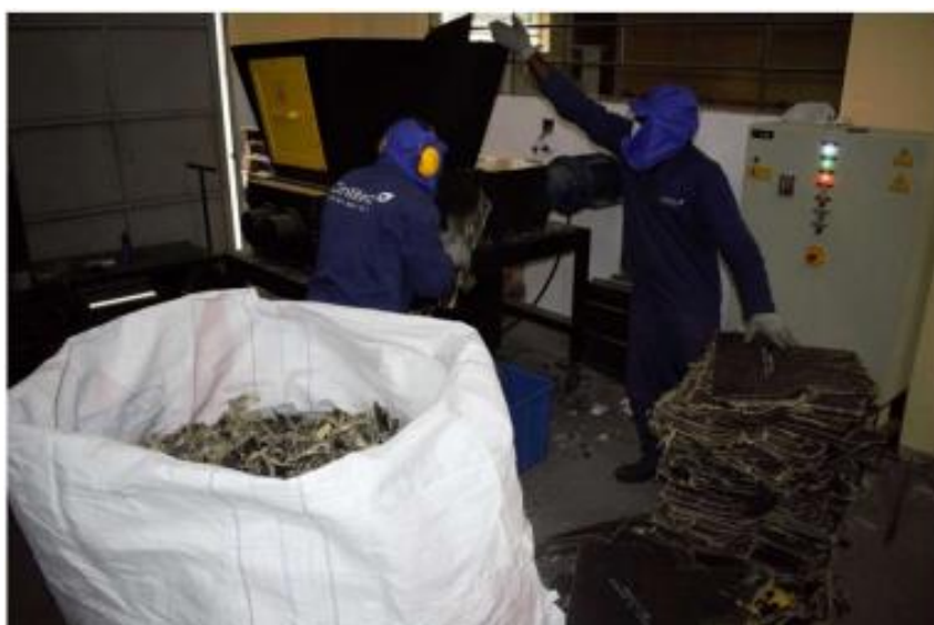
Foto 10: Destruição por picotamento de placa balística rígida. Fonte: Seç Com Soc / 21º D Sup (2021)
