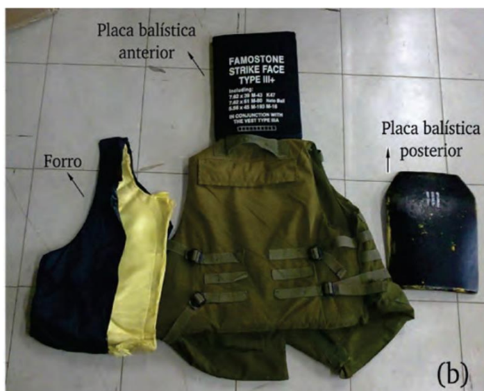
FOTO 05: Colete balístico desmontado, com fibra de poliaramida exposta. Fonte: CARDOSO et al. (2011)
