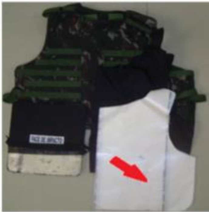
FOTO 06: revestimento de PEUAM em colete balístico Fonte: VIVAS et al. (2015)
