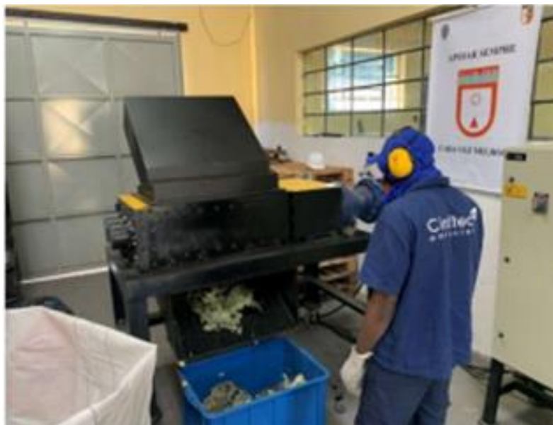
FOTO 08: Capacete sendo triturado na máquina trituradora. Fonte: Seç Com Soc / 21º D Sup (2021)
