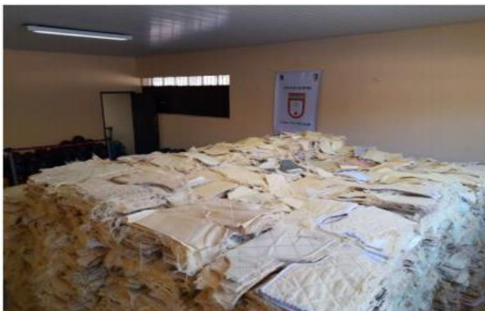
Foto 13: Pilhas de placas flexíveis de coletes balísticos divididos ao meio.
