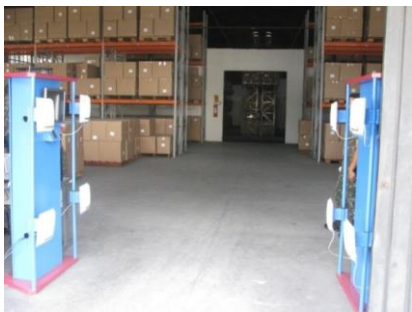
Figura 6: Portal de identificação RFID Fonte: DIAMANTINO, 2011
