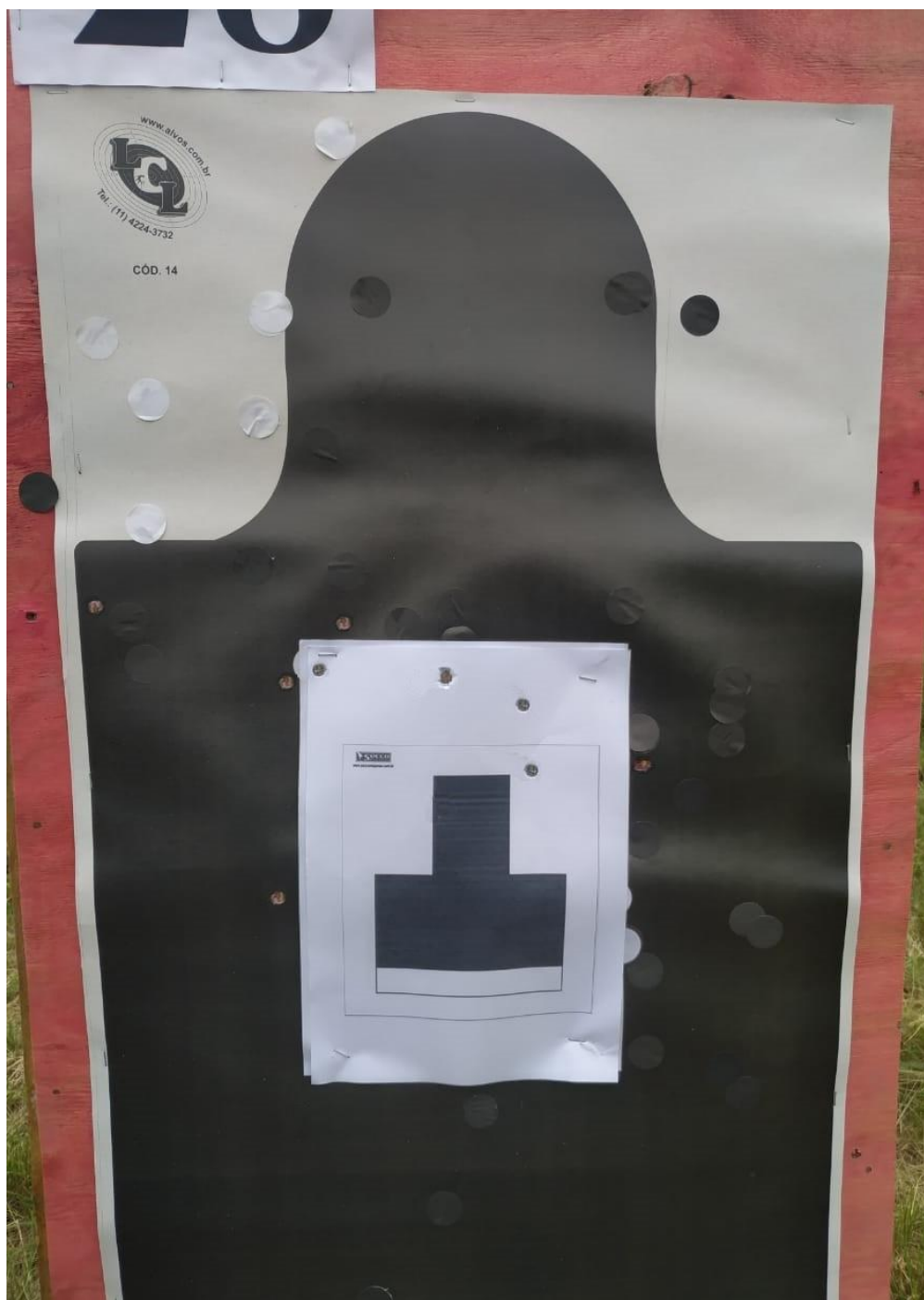
Figura 9 – Resultado dos disparos do Fuzil 5,56 mm IA2 em modo automático
