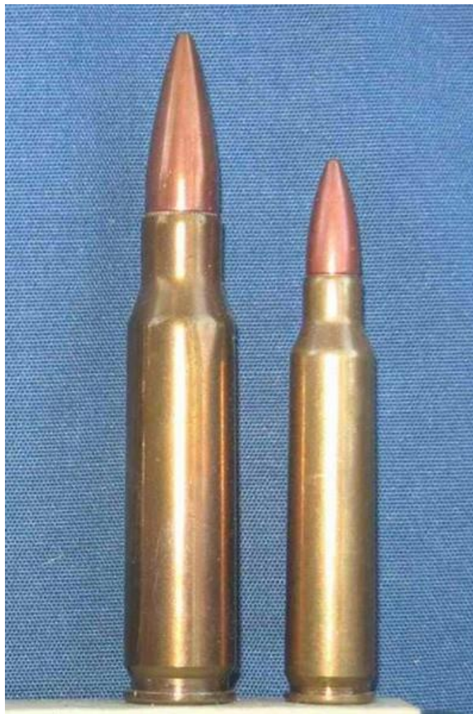
Figura 17 – Munições: a esquerda o 7,62 x 51 mm M80 e à direita o 5,56 x 45 mm M193
