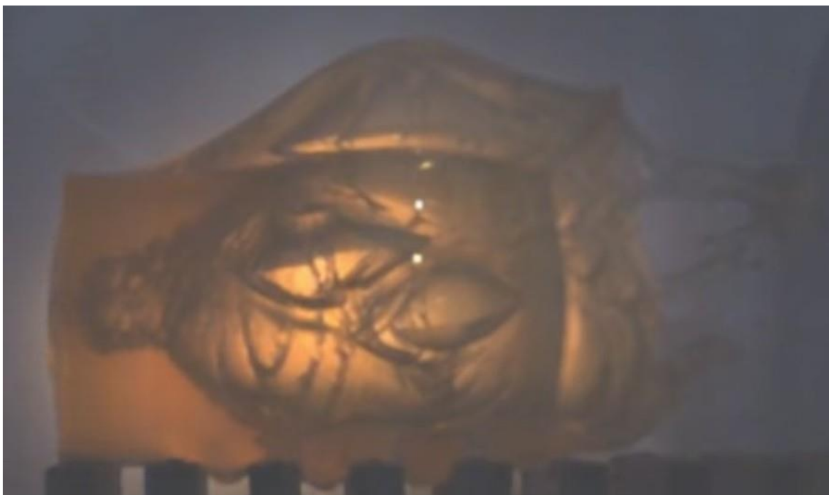
Figura 16 – Teste da munição 7,62 X 51 mm na gelatina balística
