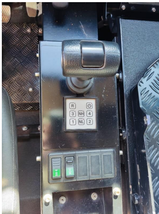
Figura 5 – Câmbio viatura Astros MK6 Fonte: arquivo pessoal
