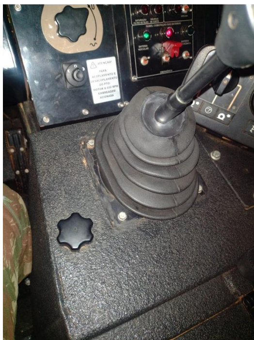
Figura 6 – Câmbio viatura Astros MK3M Fonte: arquivo pessoal
