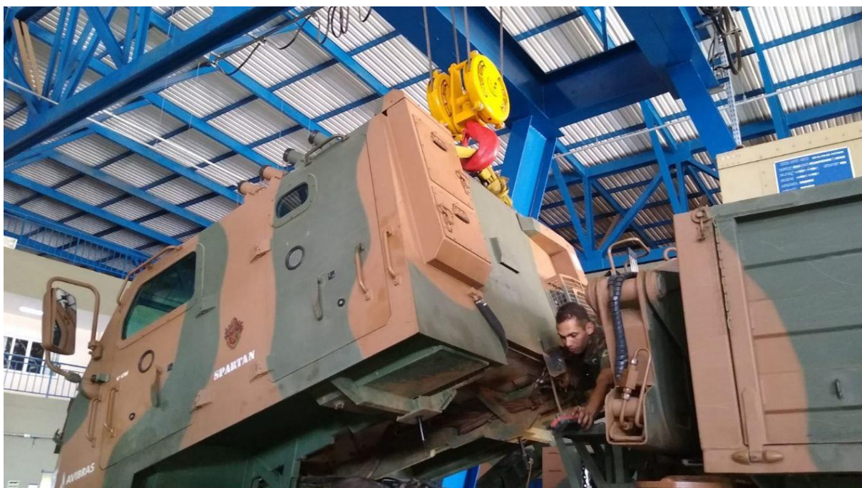
Figura 1 – Basculamento da cabine Mercedes Benz
