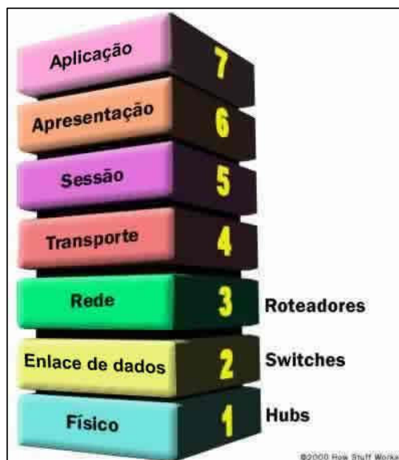
Figura 3 - Representação do roteador e do switch no modelo OSI. Fonte: Prado W. (2009).
