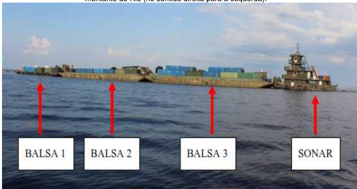
Figura 15 – Localização da Eco Sonda na composição do módulo logístico. Deslocamento à montante do Rio (no sentido direita para a esquerda).
