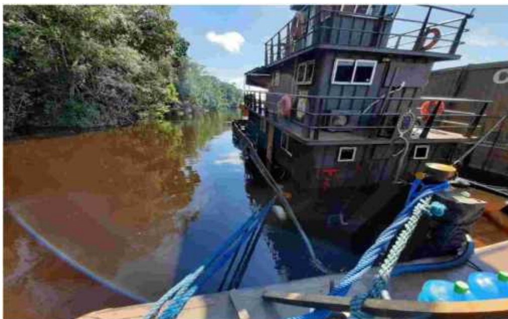
Figura 16 – Empurrador AUARIS submerso após colidir em pedras no leito do Rio Negro.
