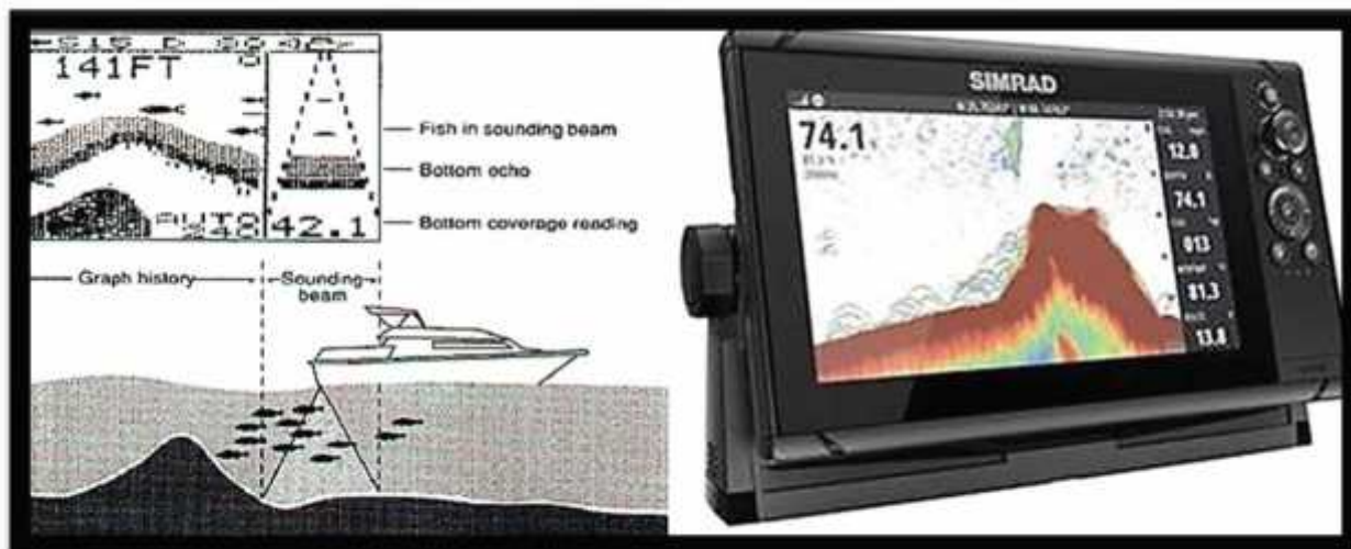
Figura 14 – Função da Eco Sonda e sua visualização no “Chartplotter”.
