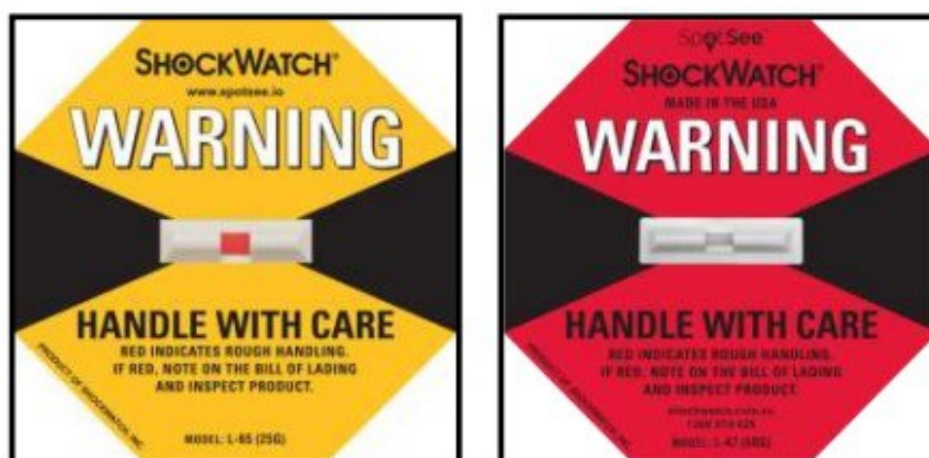
Fig. 03 – Shockwatch 25G (amarelo) acionado e Shockwatch 50G (vermelho) não acionado.
