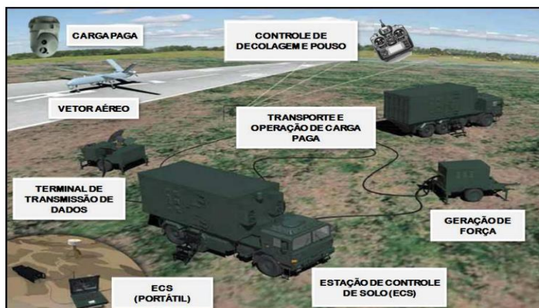
Figura 4: Módulos funcionais do SARP.
