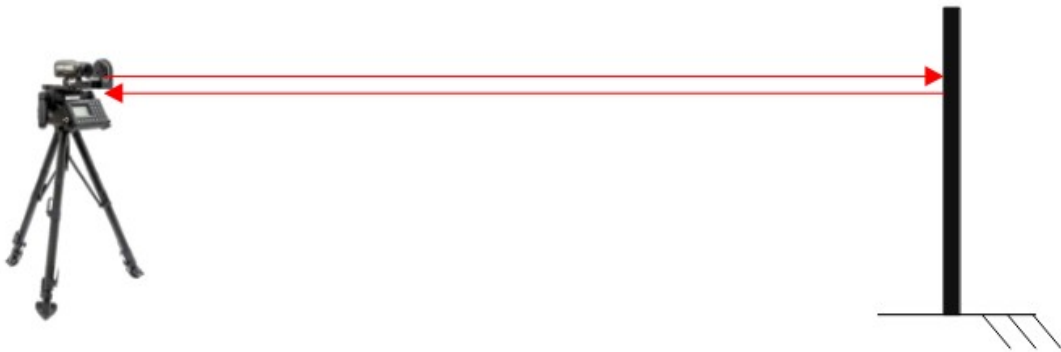
Figura 2: Caminho percorrido pelo laser do AGLS.
