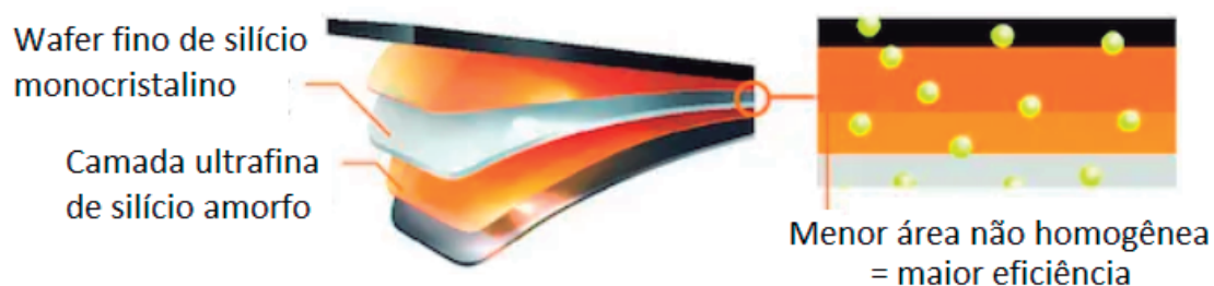
Figura 7 Estrutura de wafers de silício de heterojunção
