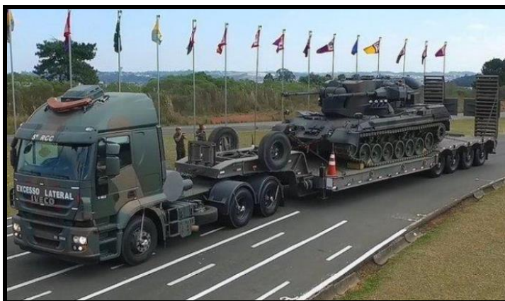
Fig 3-13 – Exemplo de VTE tipo prancha de 60 toneladas
