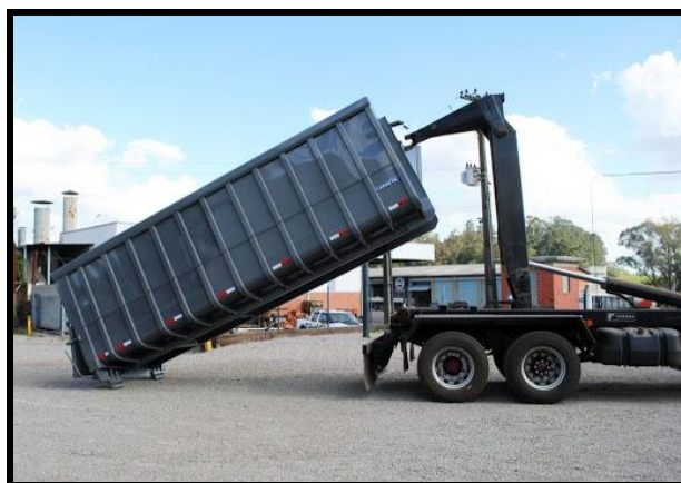
Fig 3-10 – Viatura de transporte não especializado ( Roll On/Roll Off )
