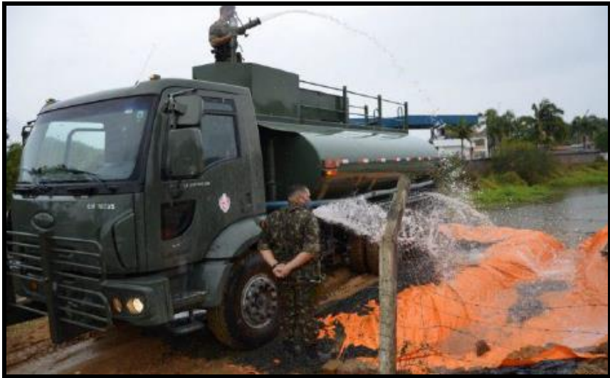
Fig 3-8 – Exemplo de VTE tipo tanque (caminhão pipa) de 12.000 litros
