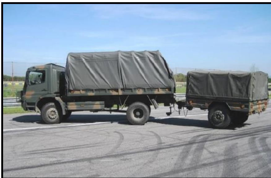
Fig 3-5 – Exemplo de VTNE com reboque não especializado de 1,5 toneladas
