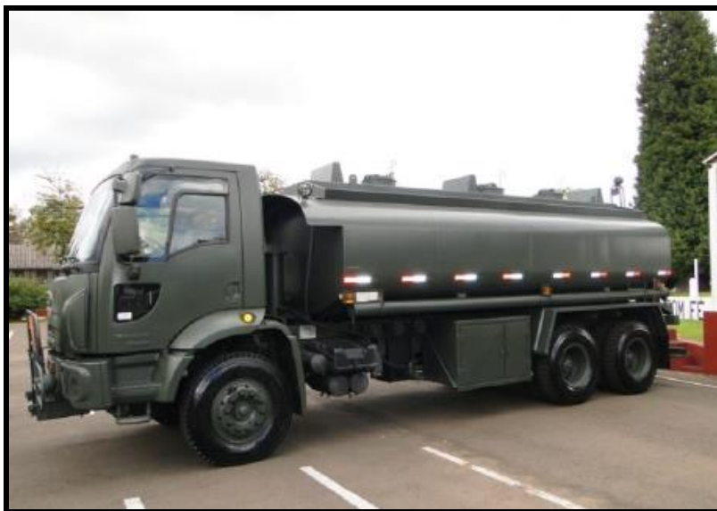
Fig 3-7 – Exemplo de VTE tipo tanque (caminhão-cisterna) de 15.000 litros
