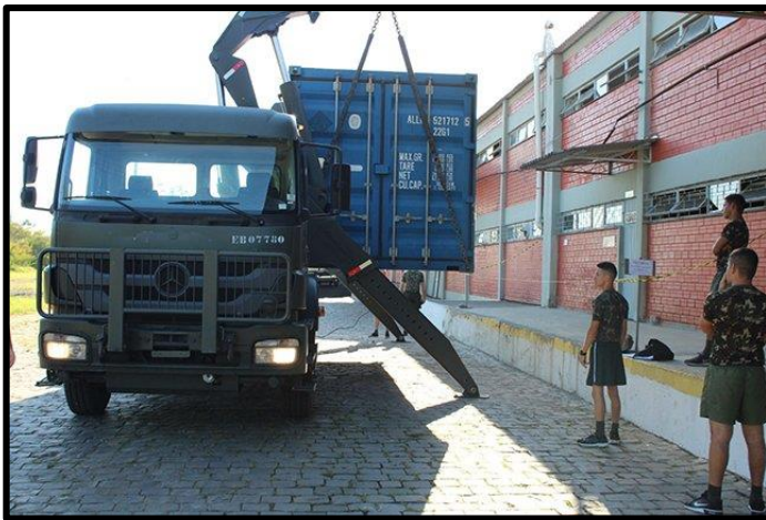
Fig 3-4 – Exemplo de viatura de transporte especial ( sidelifter ) – reserva orgânica de classe I
