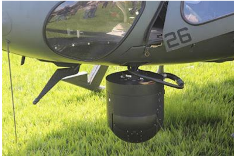
Figura 3 — Helicóptero Fenec equipado com Sistema Olho de Águia – SOA
