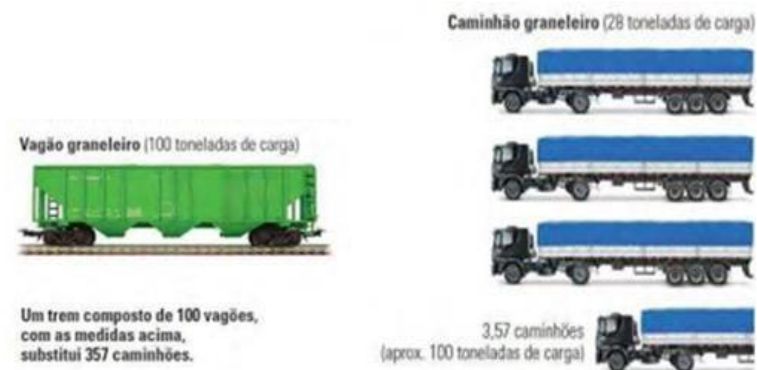
Figura 6 – Comparação da capacidade de carga entre os setores rodoviário e ferroviário
