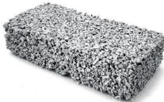
Figura 6 – Tijolo ecológico de pneus
