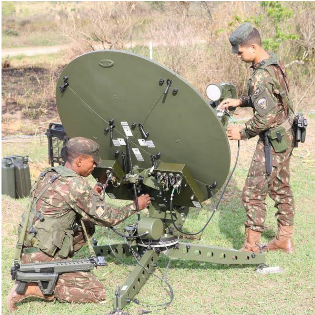
Figura 2 — militares do 20ª Cia Com Pqdt montam uma antena do SISCOMIS
