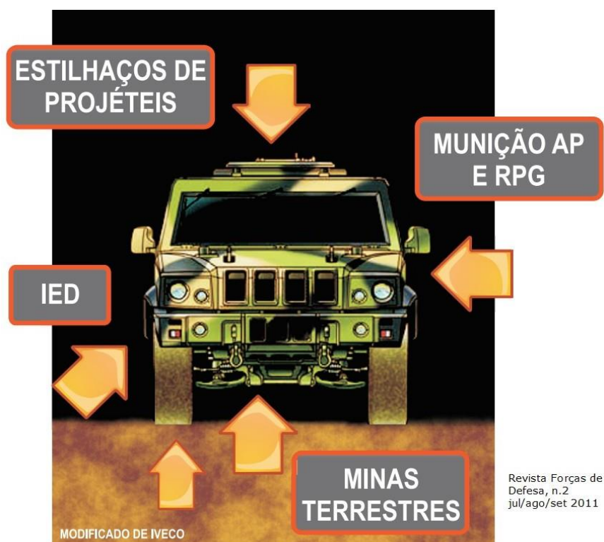
FIGURA 23 – Blindagem modular e célula de sobrevivência
