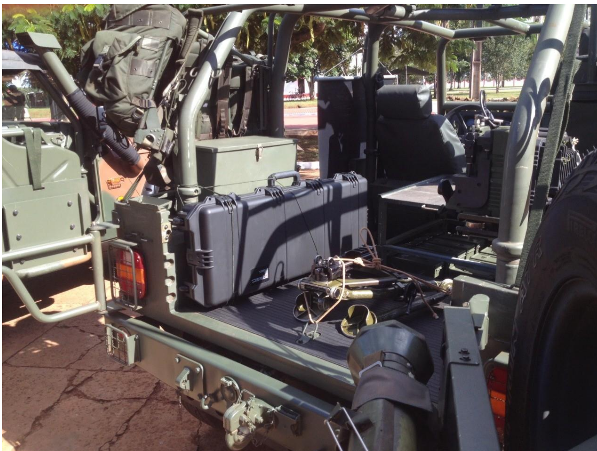
Figura 10 - Posições de ancoragem de materiais na VTL Rec Marruá
