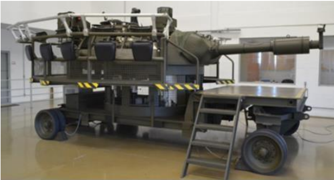
Figura 6 – Simulador de Procedimento de Torre – SPT
