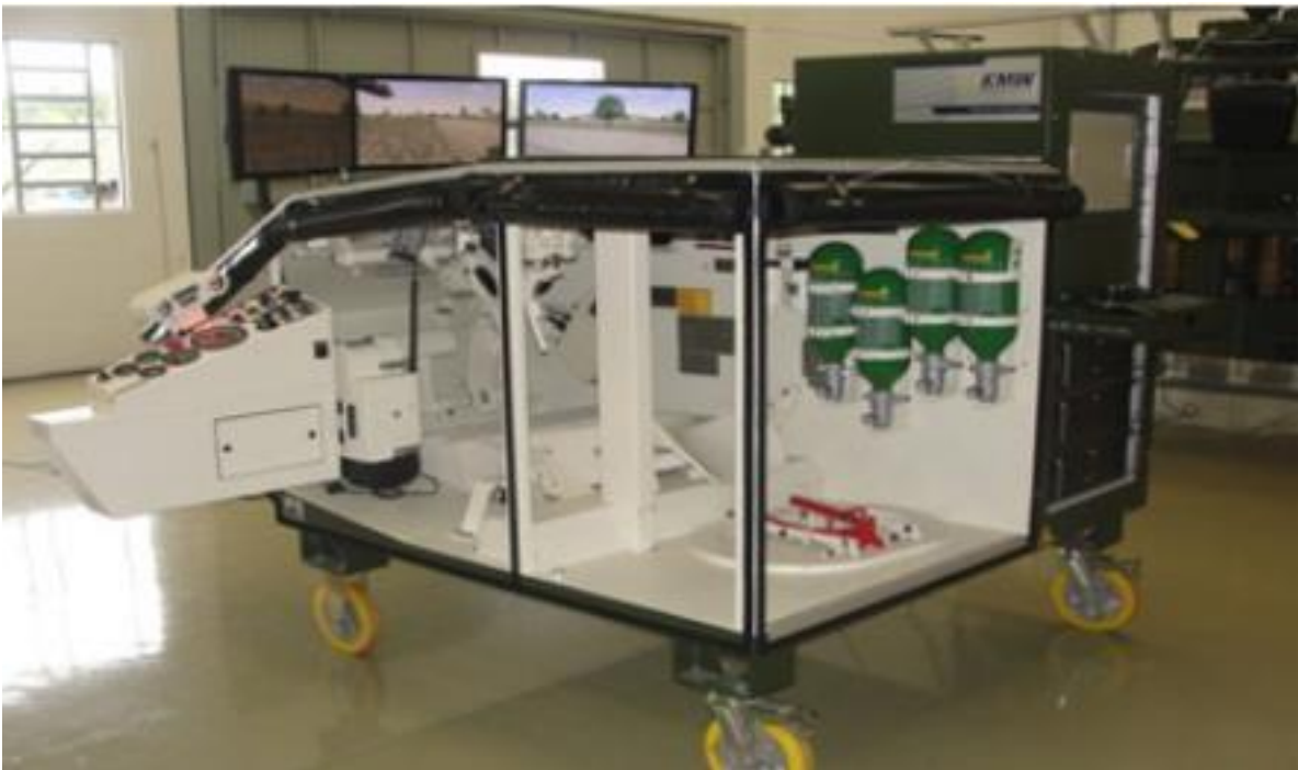
Figura 7 – Simulador de Procedimento de Motorista – SPM
