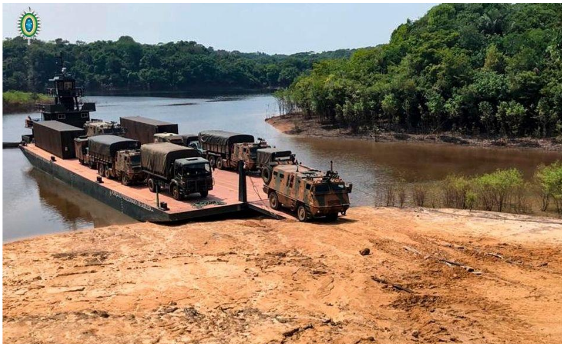
Figura 2- Uso do Binômio Empurrador Fluvial - Balsa Fonte: CCOMSEx apud Bastos Jr
