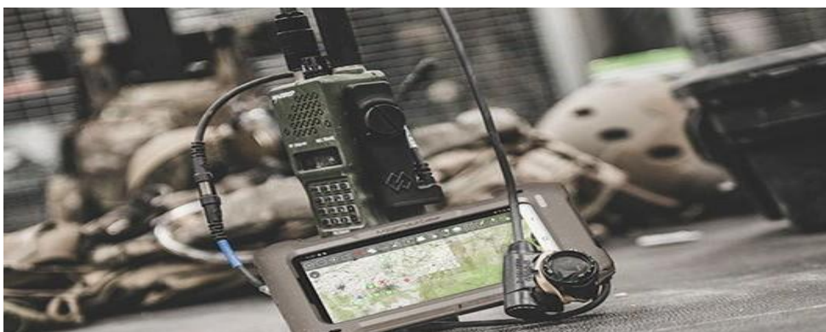
FIGURA 4: Equipamento de comunicação integrado com equipamento VHF.
